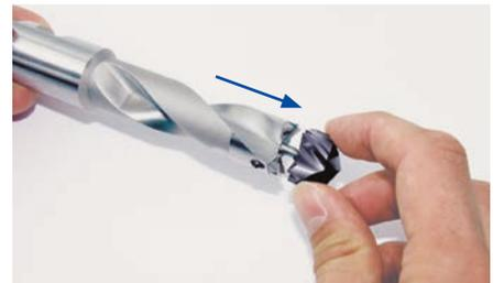
3. Ziehen Sie den Bohrkopf aus der Verzahnung.
