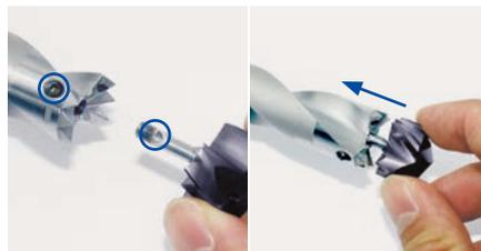
2. Stecken Sie den neuen Bohrkopf auf den Halter.
